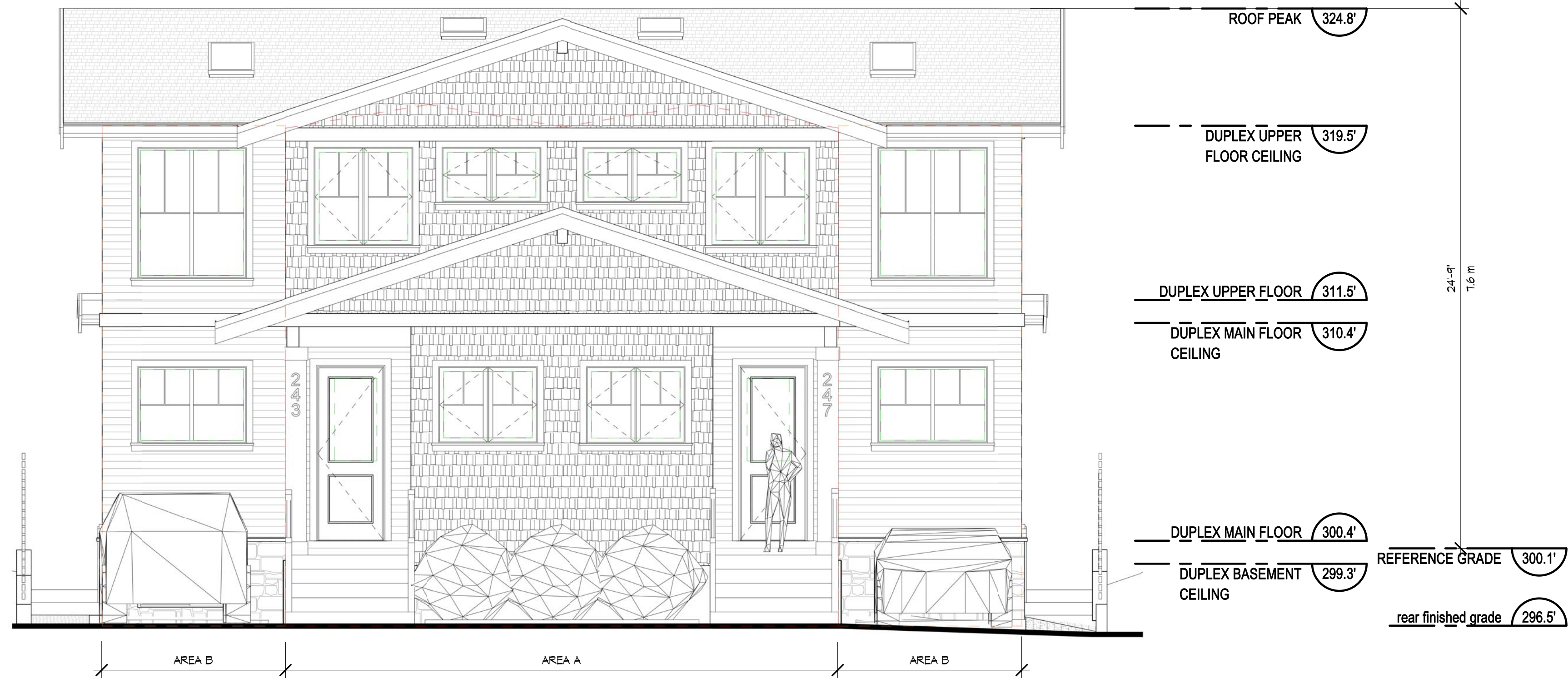
DUPLEX FRONT (LANE) ELEVATION
